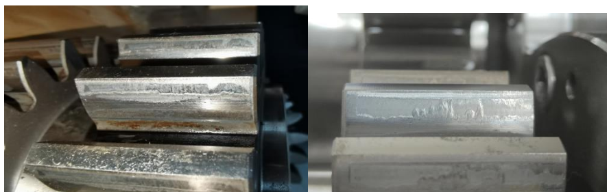
图 11 A 试验前齿面形貌
