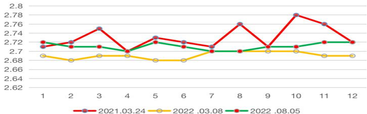
5074机车压缩压力变化对比曲线 2022.06.23/10.22添加MAT
